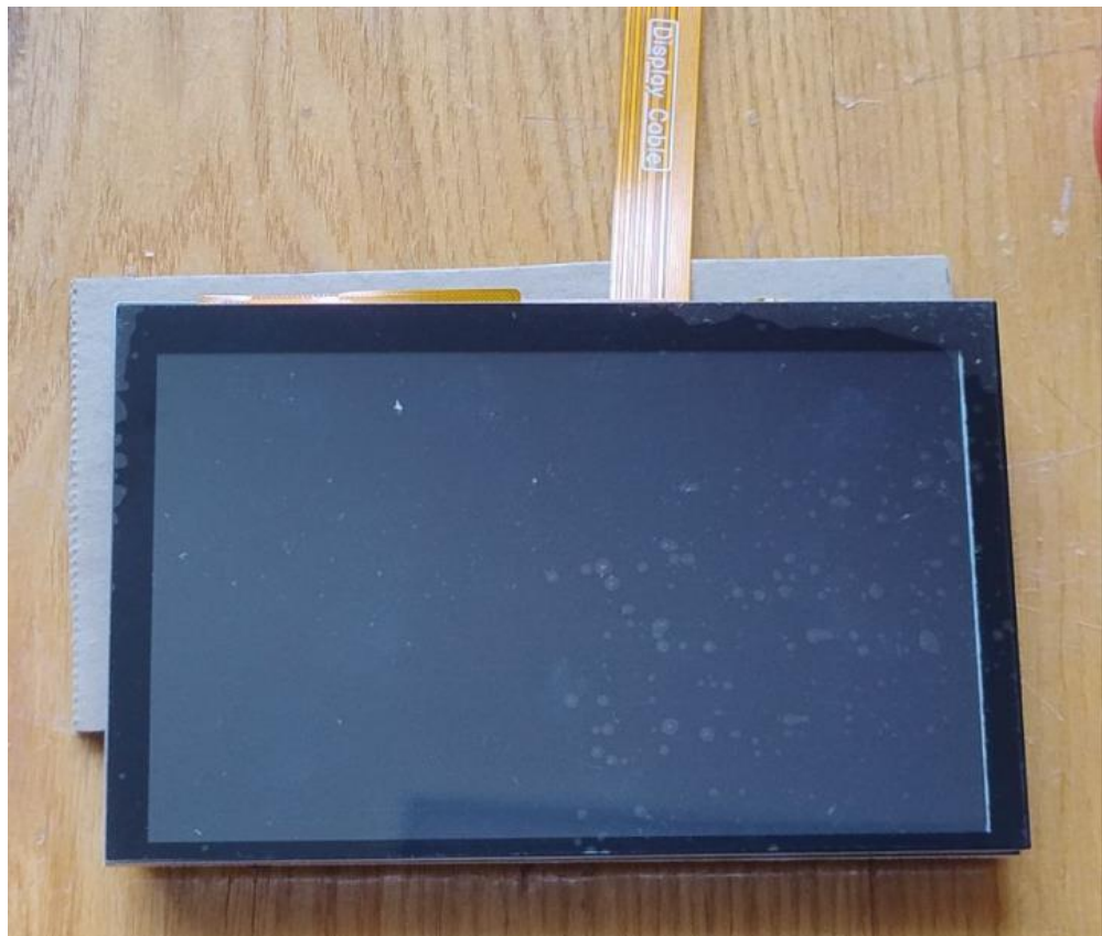
Рисунок А.2 – Дисплей Raspberry Pi 5.0 inch
