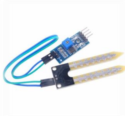
Рисунок 4 – Датчик вологості ґрунту
