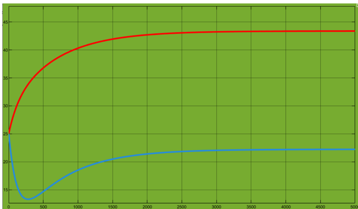
Рисунок 3.7 – Температури радіаторів гарячої та холодної сторони охолоджувача.
