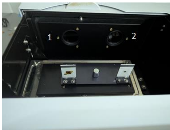
Рисунок 2.4 – заводська приставка на якій проводилось вимірювання пропускання
