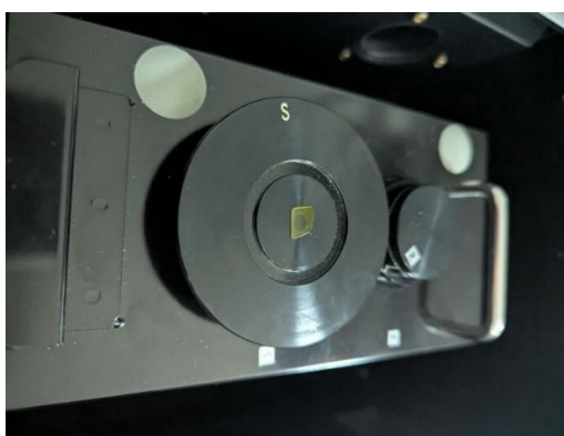
Рисунок 2.5 – заводська приставка на якій проводилось вимірювання відбиття
