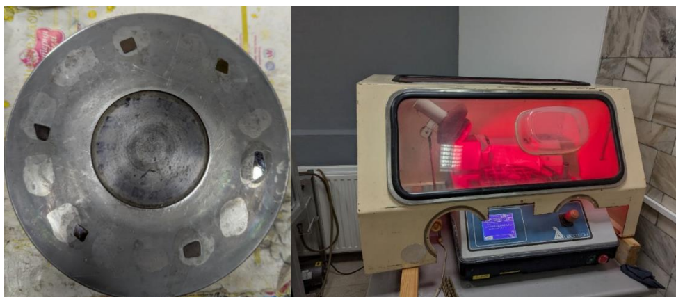
Рисунок 2.2 – а) зразки на диску, б) полірувальний станок Logitech PM5
