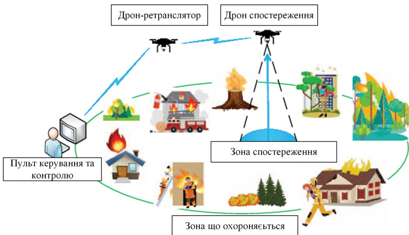
Рисунок 1.8 - Модель системи спостереження на базі дронів з ретрансляторами запропонований в дослідження [49]
