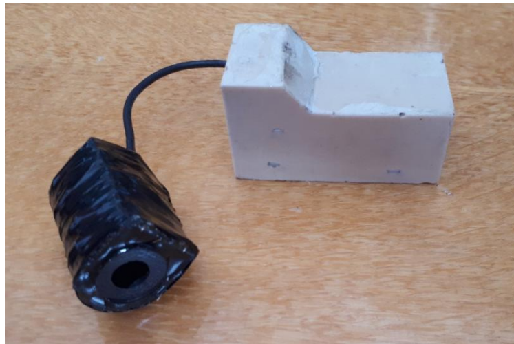
Рис. 4.9. Фото герметизованого епоксидним компаундом пристрою ідентифікації ОЗЗ
