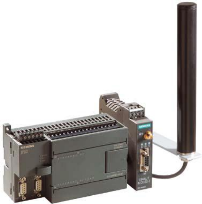
Рис. 4.14. Обладнання для підключення до SCADA-системи ПАТ «Чернігівобленерго»
