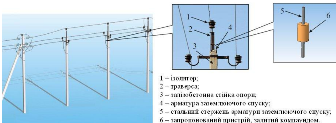
Рис. 2.6. Розміщення пристрою ідентифікації місця ОЗЗ в мережі 6-10кВ
