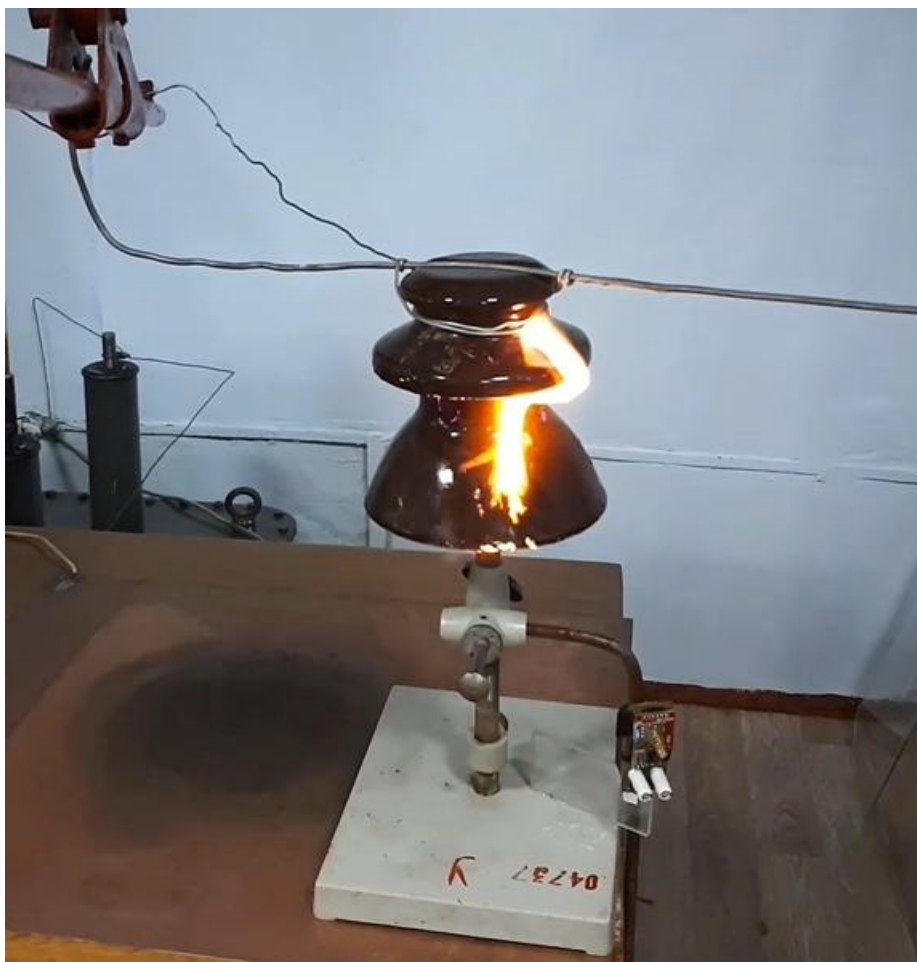
Рис. 4.8. Фото пробою ширьового ізолятора ШФ-20 під час лабораторного дослід з пристроєм ідентифікації ОЗЗ
