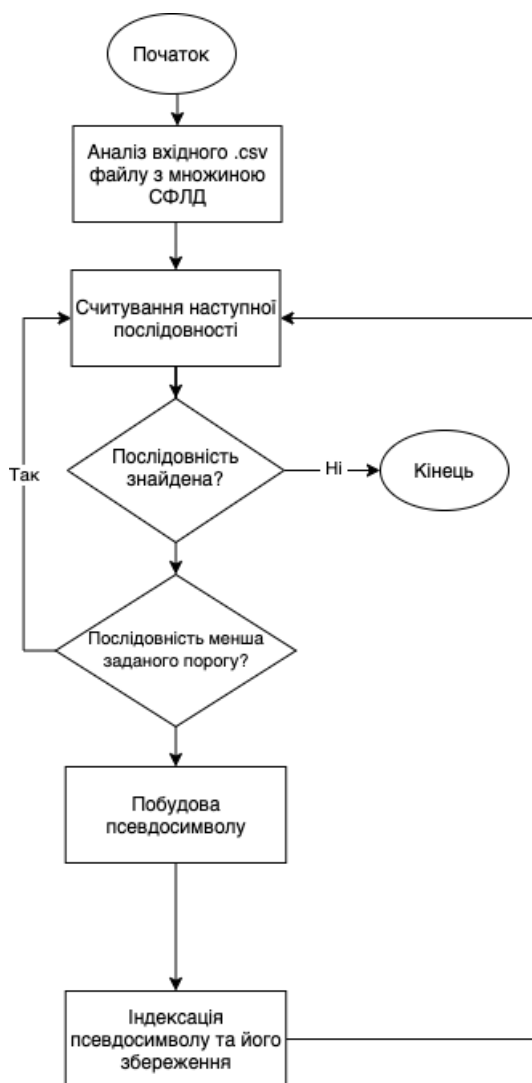
Рисунок 4.2 – Блок-схема алгоритму функції розкладання вхідного .csv фвіла
