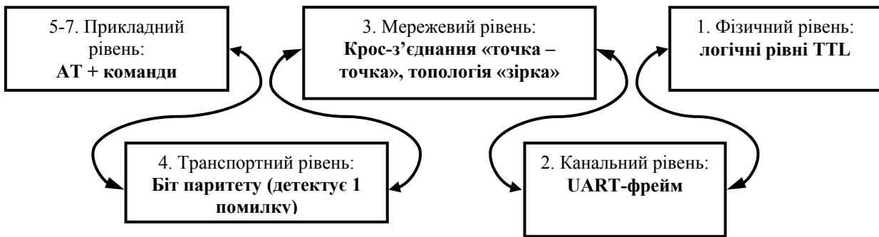
Рис. 2. Стек протоколів між бездротовим модулем та МК
