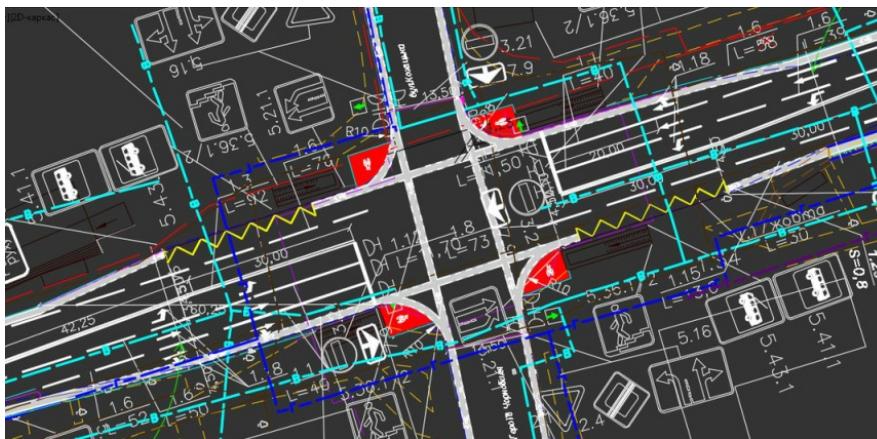
Рис. 3. Захисні смуги та зони очікування на перехресті проспекту Миру з вул. Героїв Чорнобиля та проспекту Миру з вул. Козацька
