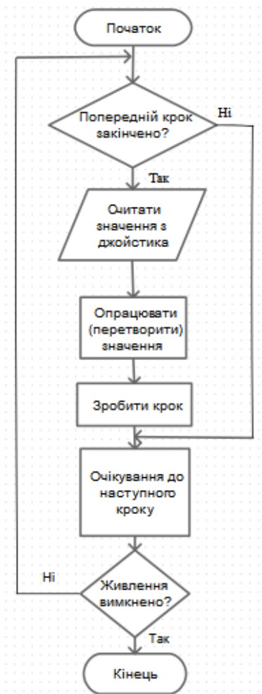
Рис. 3. Блок-схема програми для однієї осі маніпулятора
