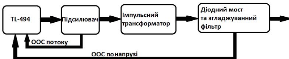
Рис.1. Структурна схема бортового DC/DC перетворювача електроенергії для живлення електронних пристроїв
