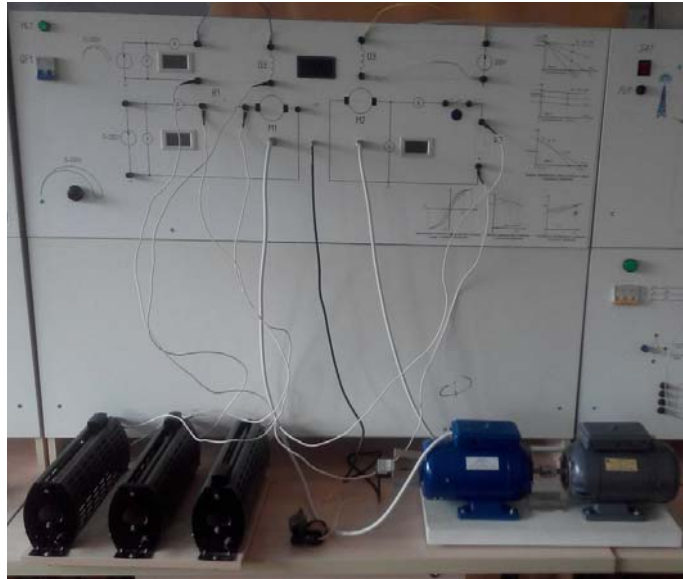
Рис. 1. Стенд для дослідження роботи машин постійного струму
