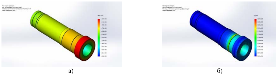
Рис. 6. Результати статичного аналізу шпинделя а) – карта навантажень, б) – карта переміщень точок
