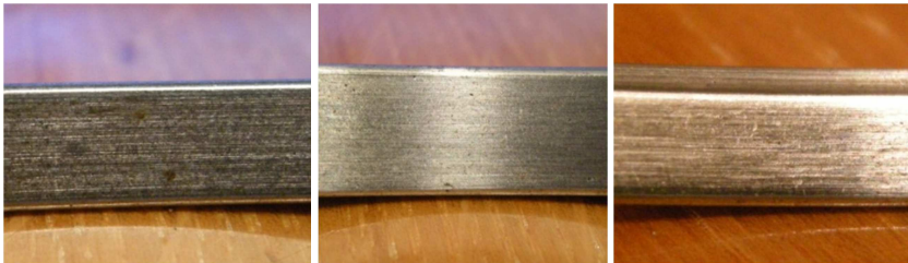
Рис. 1. Шорсткість робочих поверхонь крутильних кілець
