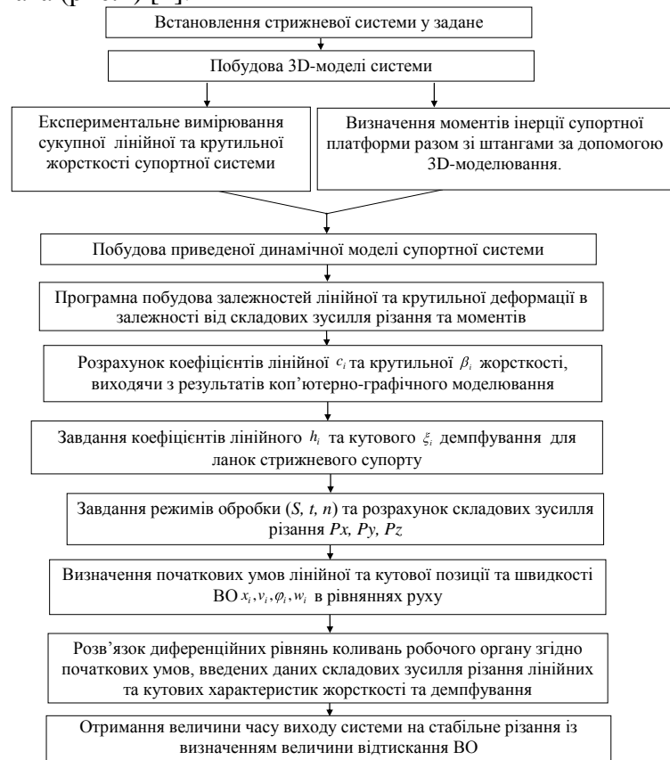
Рис.1 – Об'єкт та методика досліджень: а) - токарний верстат із стрижневою супортною системою; б) - послідовність визначення динамічних параметрів супортної системи
