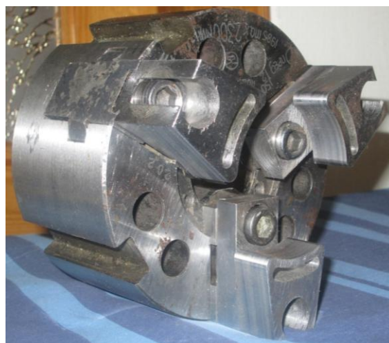
Рис. 3 – Механізований токарний затискний патрон із адаптивними ЗЕ для затиску заготовок в діапазоні діаметрів 60–70 мм
