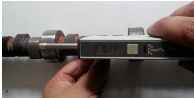
Рис. 12. Вимірювання шорсткості обробленої поверхні деталі
