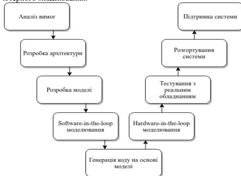
Рис. 1. Типовий процес розробки вбудованої системи з використанням комп'ютерного моделювання [2]
