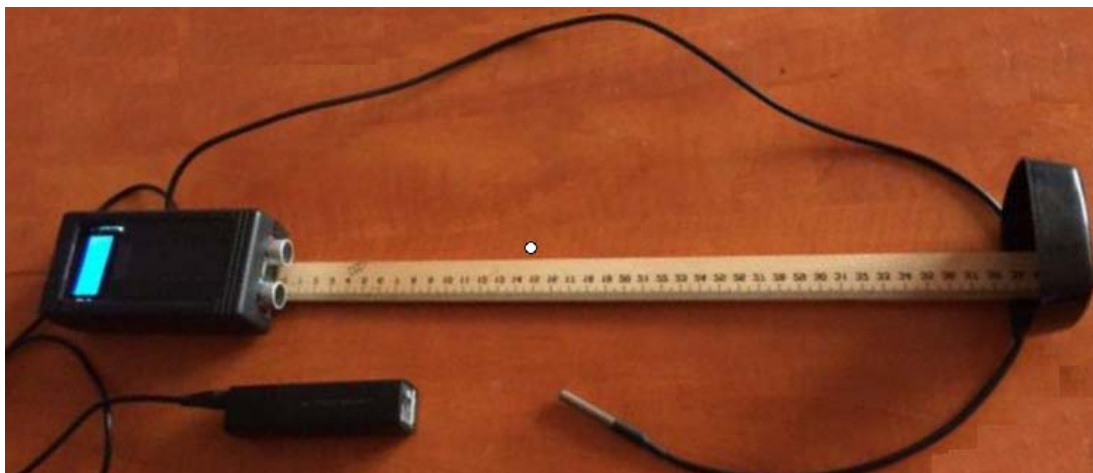
Рис. 3. Зовнішній вигляд імпульсного акустичного безконтактного термометра
