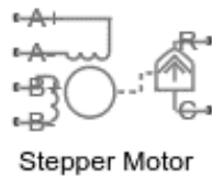
Рис. 1. Блок Stepper Motor, який реалізує модель крокового двигуна.
