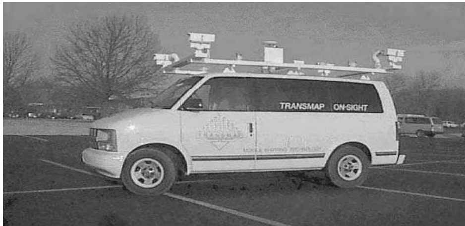
Рис. 2. Мобільна система картографування – MCK (Mobile Mapping System – MMS)
