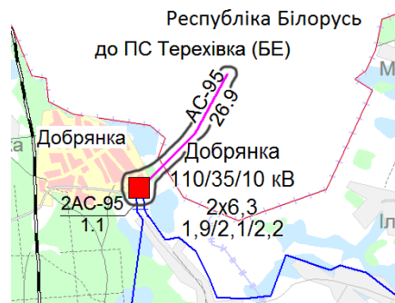
Рисунок 1 – Живлення ПС «Добрянка» від ПС «Терехівка»
