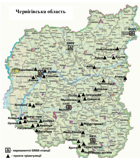
Рис. 1. Схема пунктів триангуляції Чернігівщини, на яких виконували GNSS спостереження
