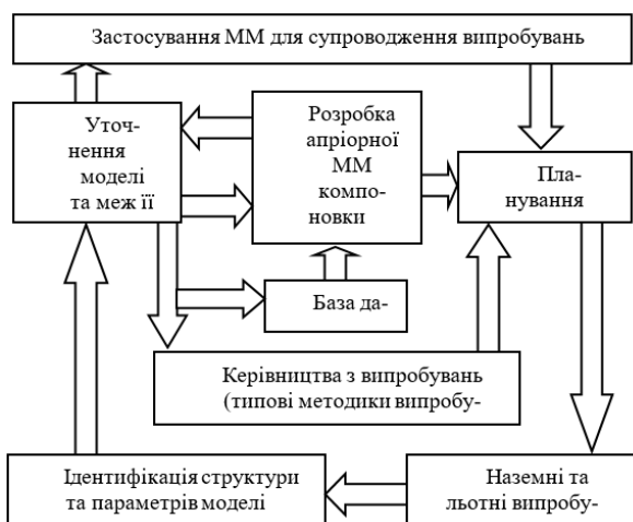
Рис. 1. Взаємозв'язок між математичним моделюванням та випробуваннями ПС.
