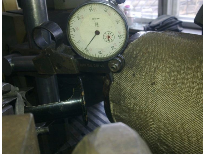
Рис. 4. Експериментальне дослідження жорсткості голки
