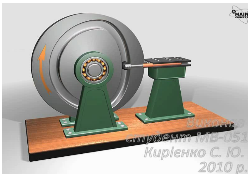
Рис. 1. 3D модель роботи дискового кулачка
