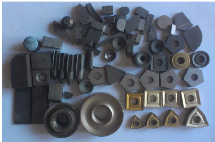
Рис. 5. Зовнішній вигляд виробів з регенованих твердих сплавів зі зміцненням
