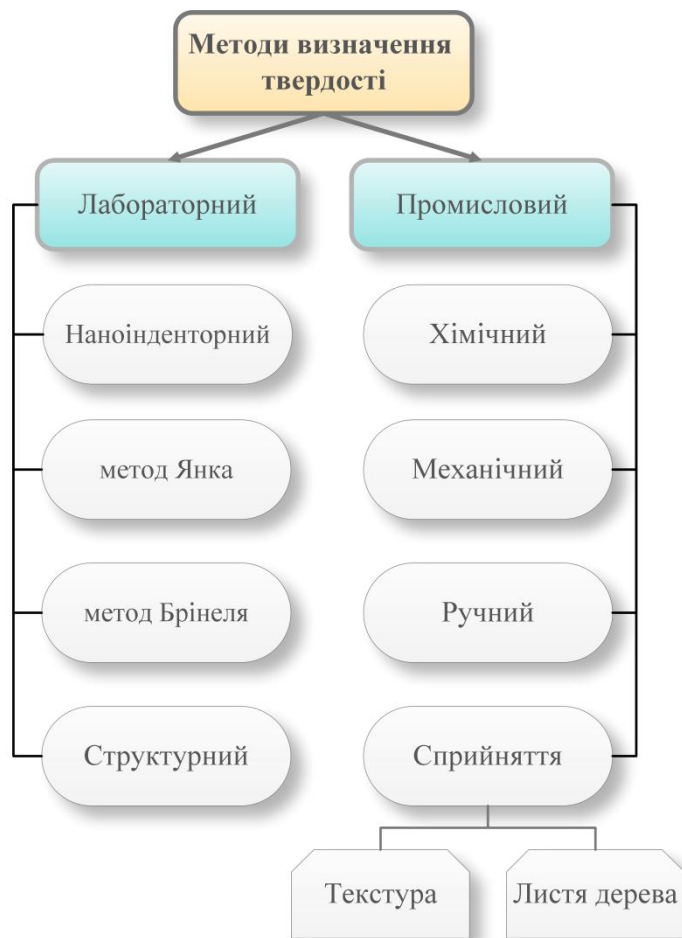
Рис.1. Класифікація основних методів визначення твердості деревини
